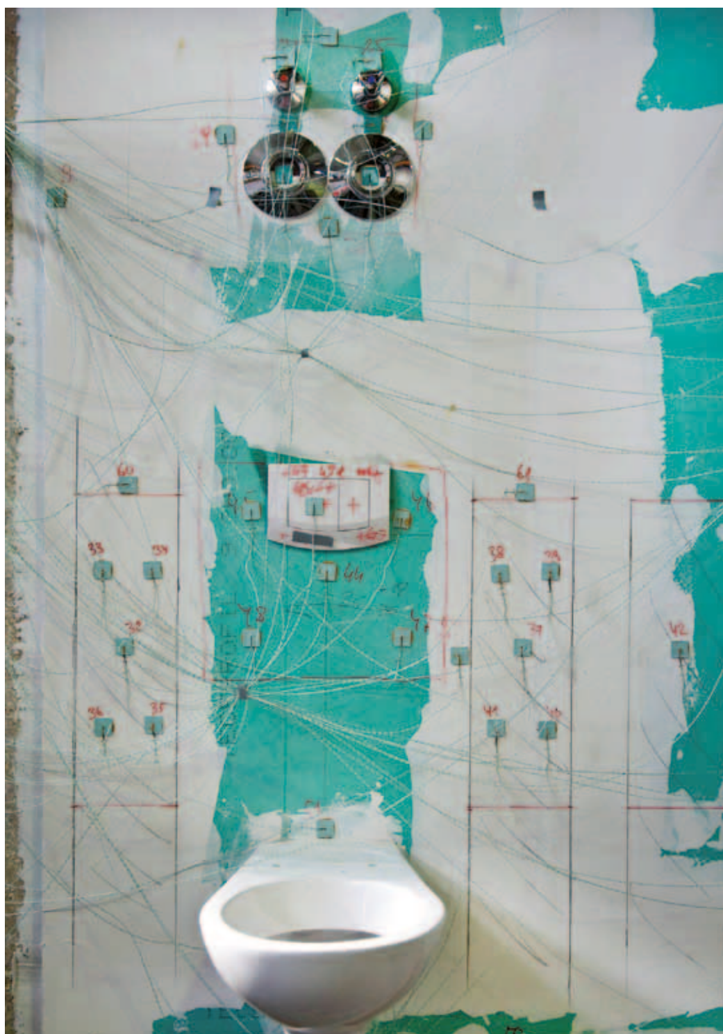
Fig. sopra: impianto per la misurazione della rumorosità presso il Fraunhofer Institut di Stoccarda.
