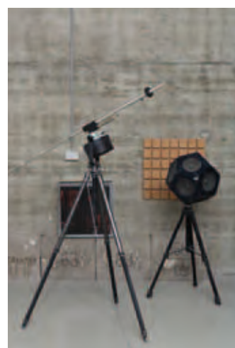
Fig. sopra: impianto per la misurazione della rumorosità presso il Fraunhofer Institut di Stoccarda.
