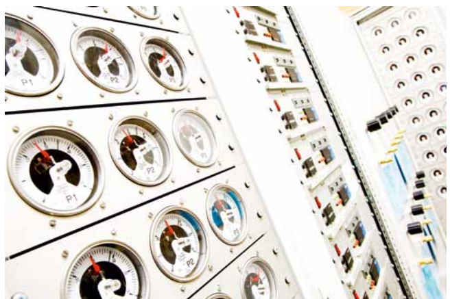
Anlage zur Überprüfung der Zeitstandfestigkeit von Installationsrohren.
