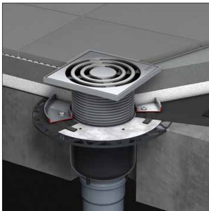
Einbau im Kellerbereich, Abdichtung mit Klemmflanschabdichtung
