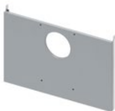
TECEbox Bauraumabdeckung: Stahlblech mit aufgeschraubter Glasfaser-Leichtbetonplatte. Zur vollflächigen Verkleidung des unteren Bauraums der TECEbox mit verfliesungsfähiger Oberfläche.
