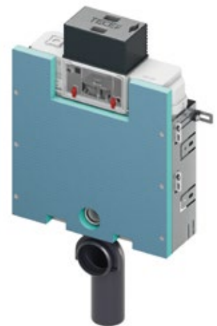
TECEbox WC-Modul mit Uni-Spülkasten und Fliesenträger-Front, Bauhöhe 820 mm: WC-Modul für den Einbau in eine gemauerte Vorwand vor einer Massivwand, in der Tiefe verstellbar.
