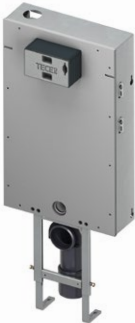
TECEbox WC-Modul mit Uni-Spülkasten, mit verfliesungsfähiger Frontverkleidung, Bauhöhe 1110 mm: WC-Modul für den Einbau in eine gemauerte Vorwand. Geschlossene, verfliesungsfähige Oberfläche aus Glasfaser-Leichtbeton. Inklusive vormontierter, höhenverstellbarer Stützfüße.
