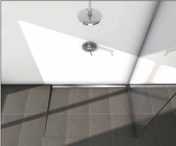
Der Einbau der Rinne „direkt an der Wand“ hat die Vorteile, dass sich die Rinne optisch zurückhaltender in das Fliesenbild einfügt und sie weniger aufwendig verfliesen muss. Das Einfügen von schmalen Fliesenteilen und damit von Fugen, zwischen Wand und Duschrinne, wie beim „wandnahen Einbau“, entfällt. Im Vergleich zum Einbau „im Raum“ benötigt man nur ein einseitiges Gefälle zur Wand – das Gegengefälle entfällt.
