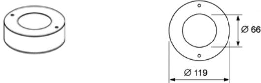
Set besteht aus Brandschutzmanschette, 2 Kreuzschlitzschrauben, Kennzeichnungsschild und 150 mm DN 50 PP-HT Rohr nach DIN EN 1451.
