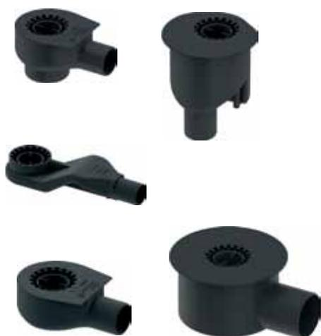
I pozzetti di drenaggio TECEdrainline sono disponibili orizzontali in 4 altezze da 53 a 133 mm ed uno con scarico verticale. I pozzetti possono essere combinati liberamente con le canalette TECEdrainline, in base alla capacità di drenaggio necessaria e all'altezza di installazione disponibile.
