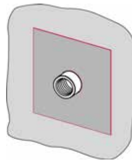
Bild 2: Dichtmanschette in noch feuchten Dichtanstrich einbetten
