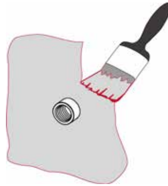
Bild 1: Aufbringen des unteren Dichtanstrichs
