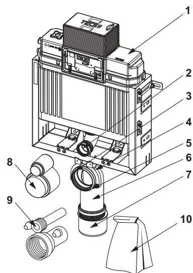
9371300 – TECEbox Módulo WC con cisterna Uni, con revestimiento frontal embaldosable, altura 1110 mm
