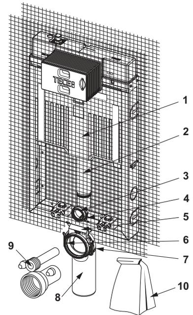
9370502 – TECEbox Módulo de inodoro con cisterna Octa II, 8 cm, para inodoro suspendido, con conexión para extracción de olores, altura de instalación 1075 mm
