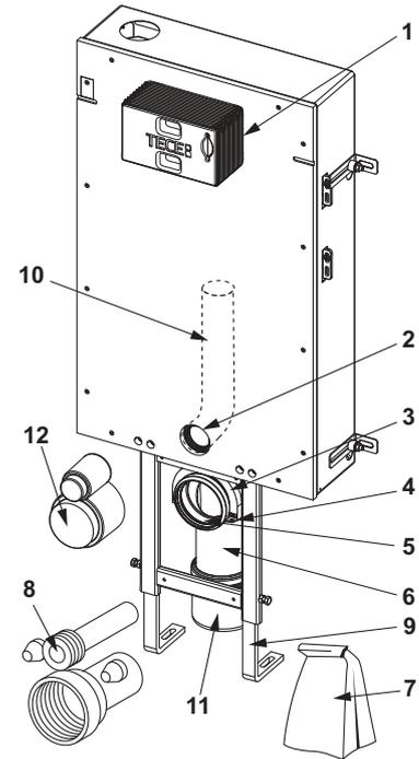
9041308 – TECEbox Cisterna Uni, con placa de montaje, altura de instalación 1060 mm
