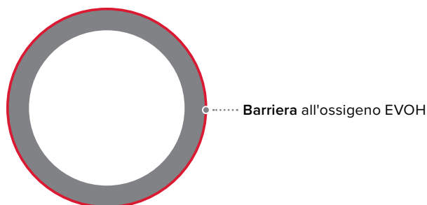
Sezione del tubo convenzionale con barriera all'ossigeno EVOH esterna.
