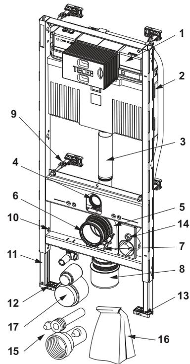
9300309 – TECEprofil Módulo WC Geronto con cisterna Uni, fijación de la cerámica para alturas de asiento de 48 cm de acuerdo con la norma alemana DIN 18040-1, altura 1120 mm
