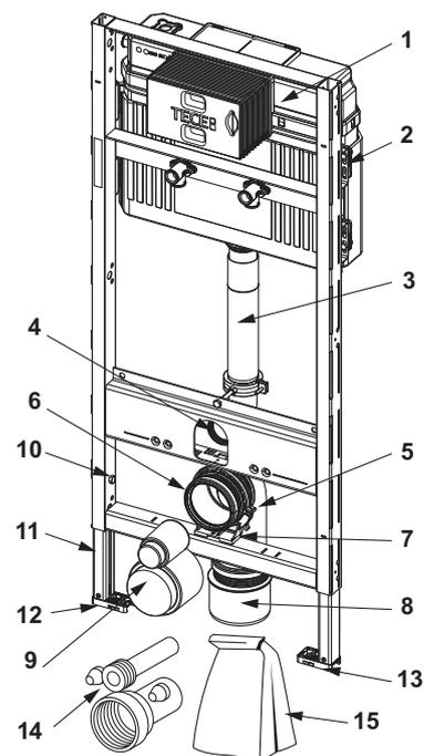
9300600 – TECEprofil Módulo de WC con cisterna Compact 320, altura de instalación 1120 mm
