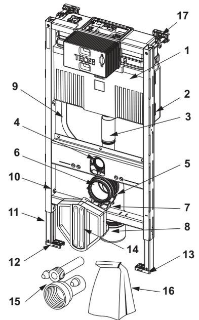
9300301 – TECEprofil Módulo WC con cisterna Uni, altura 820 mm
