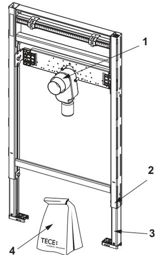
9310017 – TECEprofil Módulo de lavabo que incluye dos bloques de montaje para instalar las cápsulas de medición del contador de agua, altura de instalación 1120 mm
