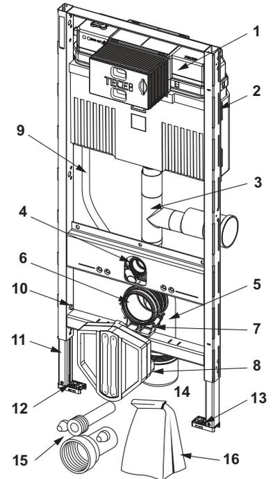
9300388 – TECEprofil Módulo WC «Kids» con cisterna Uni, para inodoro al suelo, altura de instalación de 1120 mm
