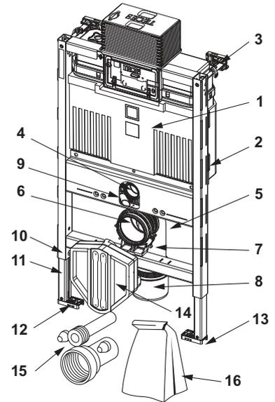
9300291 – TECEprofil Módulo WC con cisterna Uni 750, altura 750 mm
