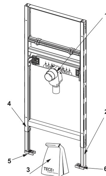
9310019 – TECEprofil Módulo de lavabo con bloqueo antiolores oculto, altura de instalación: 820-980 mm
