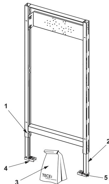
9340002 – TECEprofil Módulo de bañera/ducha con travesaño ajustable para fijaciones de montaje empotrado o en pared, altura de instalación de 1120 mm
