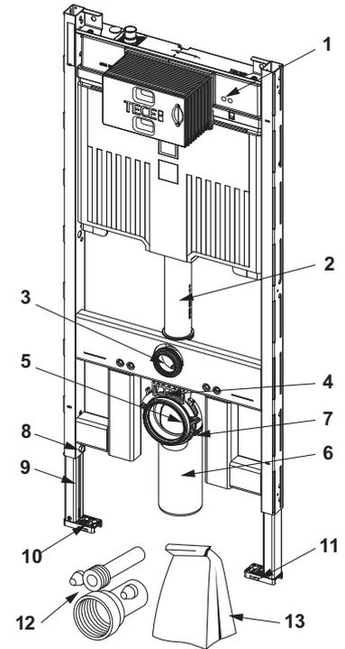
9300501 – TECEprofil Módulo WC con cisterna Octa II, 8 cm, con conexión para extracción de olores, altura 1120 mm
