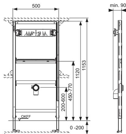
TECEprofil Módulo de bañera/ducha para grifería empotrada y exterior, altura de construcción 1120 mm
