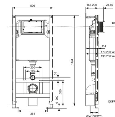
В основе всех модулей TECEspring — усиленная рама, выдерживающая нагрузку не менее 400 кг. Бачок во всех модулях оснащен системой двойного смыва с возможностью настройки. Модули TECEspring подходят для любых подвесных унитазов, но совместимы только с панелями смыва TECEspring.
