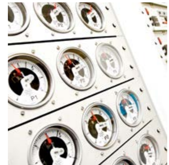
W laboratorium testującym systemy rur punkty są oznaczane i monitorowane na standardowej krzywej czasu do zerwania. W ten sposób na przykład mierzy się i rejestruje okres użytkowania próbki rury w temp. 90°C i ciśnieniu o wartości 10 barów.
