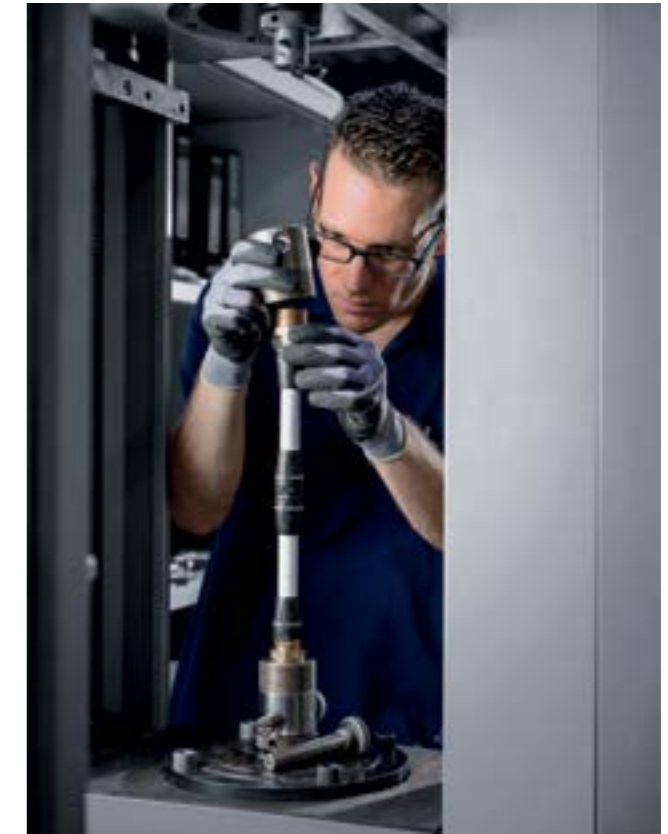
Rury i złączki przechodzą badania trwałości połączeń w celu zapewnienia maksymalnego bezpieczeństwa. Gwarantuje to długotrwałą stabilność instalacji.
