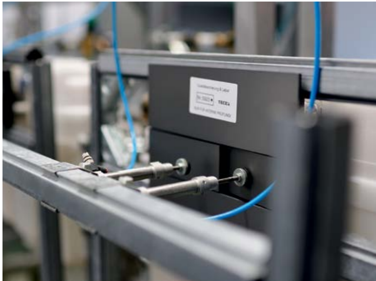
Mechanizm uruchamiający przycisk sflukujący poddaje się badaniom zmęczeniowym podczas 200 000 cykli. Po takim teście urządzenie powinno pozostać w pełni sprawne.
