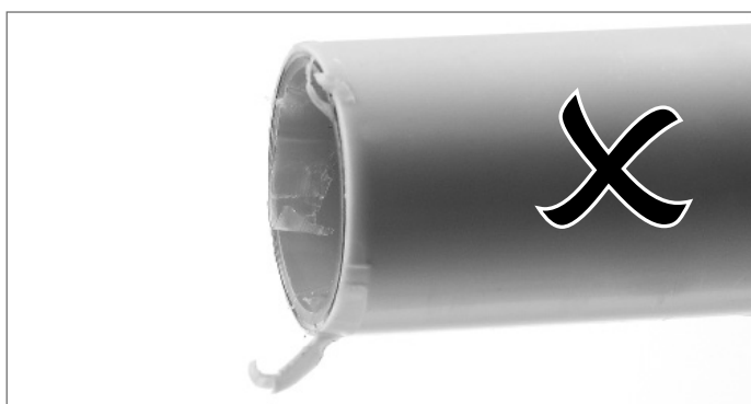
Nieprawidłowo skalibrowana i sfazowana rura
