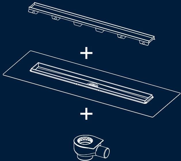
Persönliche Badgestaltung bedeutet, dass individuelle Lösungen realisiert werden wollen. Dafür bietet TECE ein breites Angebot an Längen für seine Duschrinnen an. Alle TECEdrainline Designabdeckungen sind mit allen TECEdrainline Rinnen kombinierbar und in den Längen 700 – 1.200 mm erhältlich.
